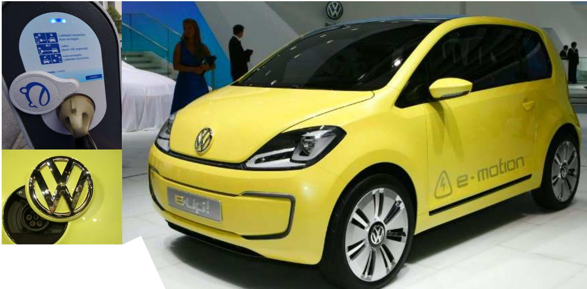
Der EU-Standard des neuen Steckersystems (7-polig, 400V, 63A) wurde April 2009 beschlossen.
